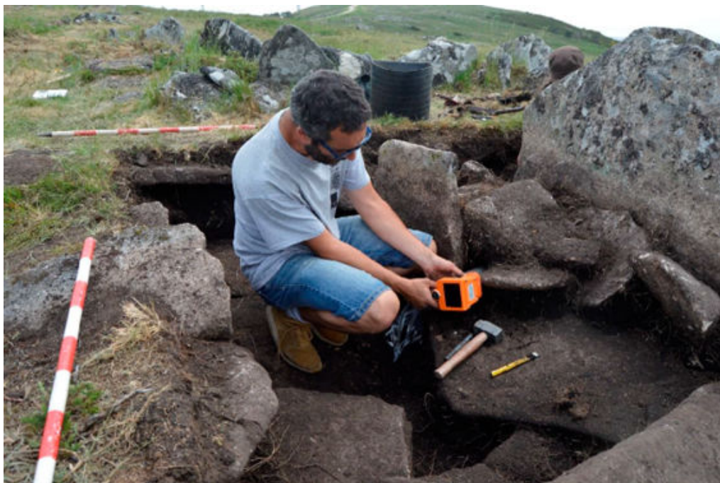
Figura 14. Proceso de medición da radiación gamma con espectrómetro de masas portátil.
