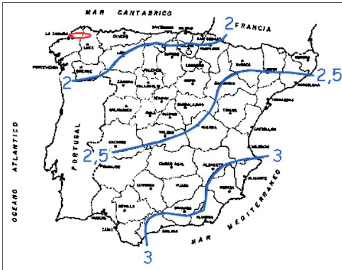
Figura 8. Mapa del coeficiente corrector del umbral de escorrentía. La ubicación de la cuenca del río Eume señalada en rojo. Fte: J.R. Témez.
