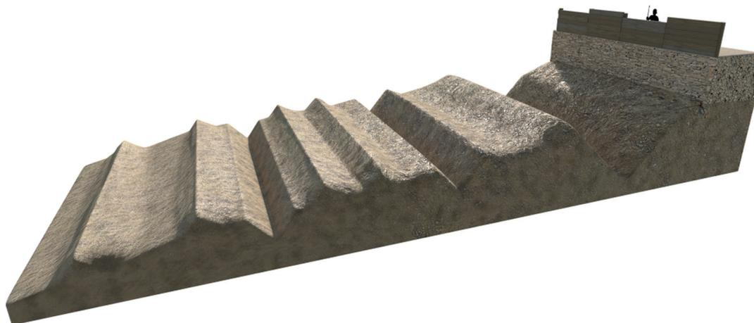
Figura 3. Representación esquemática de las defensas de tipo compuesto (IMBEAC).
