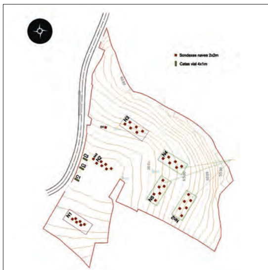
Fig. 2. Replanteo de sondeos en la finca de Monte Forte de Gabriel
